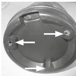
6. Connecter les câbles d'alimentation (chapitre 3 et 4). Fixer ensuite le socle de la lampe sur le support avec 3 vis taraudées de Ø3x12mm.
