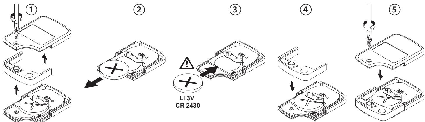
**FR-** Remplacement de la pile : Pile lithium 3V type CR 2430. Durée de vie de la pile : ±2 ans. Ne pas recharger.
