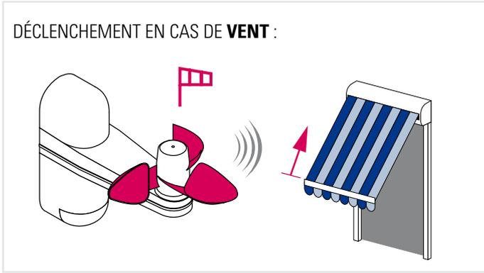
Le vent fait tourner l'anémomètre. Lorsque la vitesse dépasse le seuil de déclenchement réglé par l'installateur pendant plus de 2 secondes EOSUN-Hz envoie un ordre de repliement au moteur.
