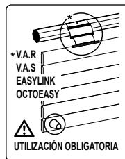
**Consejos:** El par debe seleccionarse en función de las características de la persiana arrollable, no sobredimensionar el motor. Para obtener más información sobre la compatibilidad del motor con la persiana enrollable y sus accesorios, diríjase al fabricante de la misma o a SIMU.
