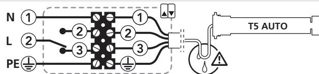
**⚠️** - Mogelijkheid om 3 parallele max. motoren op een schakelaar te kabelen.
