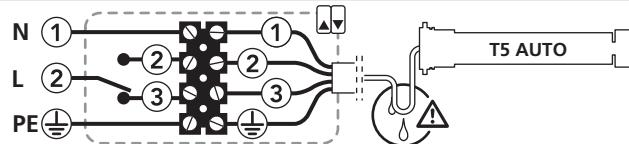
**⚠️** - Possibilité de câbler 3 moteurs max. en parallèle sur un interrupteur.
