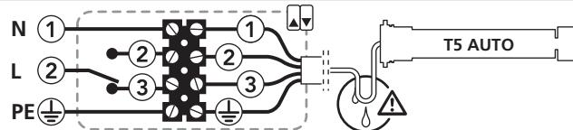
**⚠ Je možné zapojit nejvýše 3 motory v paralelním zapojení na jeden přepínač.**
