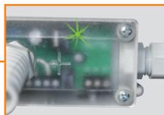
Visuelle Darstellung der ordnungsgemäßen Funktion der Schaltleiste dank eines LED-Signals, das durch die transparente Anschlussbox zu sehen ist.
