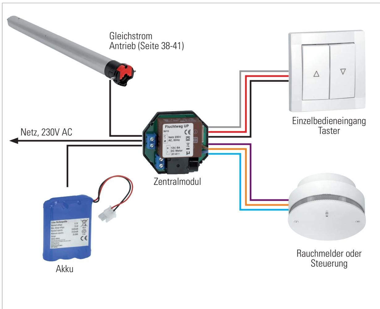
Zur Ansteuerung eines Gleichstromantriebes mit Akkuladeregulierung und Überwachung, Alarmmeldungen, Netzversorgung 230V, AC, inkl. Schnittstelle für externe Bedientaster, Zentralsteuerungen und Rauchmelder, Akkupack und Anschlußzubehör
