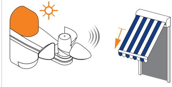
Der Wind bringt das Windrad zum Drehen. Wenn die Geschwindigkeit den vom Monteur eingestellten Schwellwert länger als zwei Sekunden überschreitet, sendet die EOSUN-Hz dem Motor den Befehl zum Einfahren. Liegt die Windgeschwindigkeit länger als 30 Sekunden unterhalb des vom Monteur eingestellten Schwellwertes, kann die Markise wieder ausgefahren werden. Die Funktion "Sonne" wird nach 12 Minuten erneut aktiviert.
