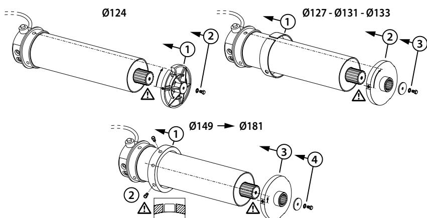
**MONTAGE DU MOTEUR DANS LE TUBE - FITTING THE MOTOR IN THE TUBE - FIXIERUNG DES MOTORS IN DER WELLE - MONTAGE VAN DE MOTOR IN DE WIKKELBUIS - MONTAJE DEL MOTOR EN EL EJE - MONTAGEM DO MOTOR NO TUBO - MONTAGGIO NEL MOTORE DEL TUBO**
