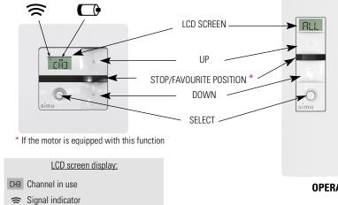
**POWER SUPPLY Wall version:** Pile lithium 3V type CR 2430
